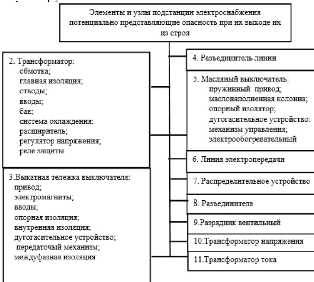
Рис.1. Элементы и узлы подстанции электроснабжения, потенциально представляющие опасность при выходе их из строя
