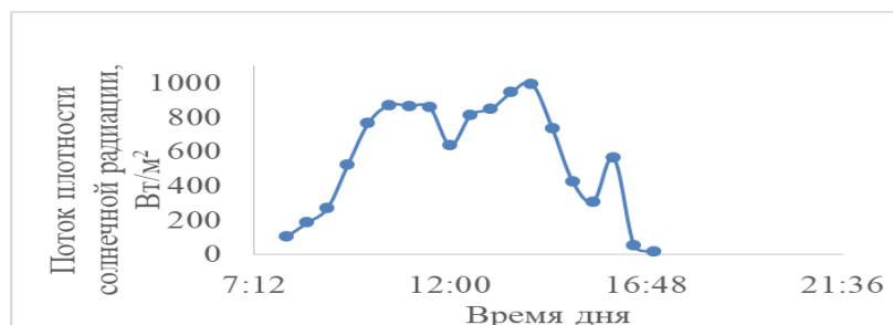
Рис. 2. Динамика изменения плотности потока солнечной радиации в течение дня (05.02.2021)
