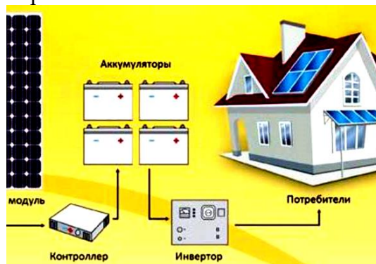
Рис.1. Структурная схема автономной ФЭС
