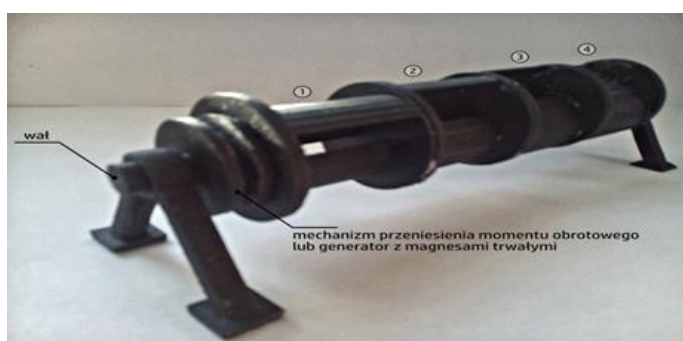
Рис.6. Пример крепления турбины ко дну канала
