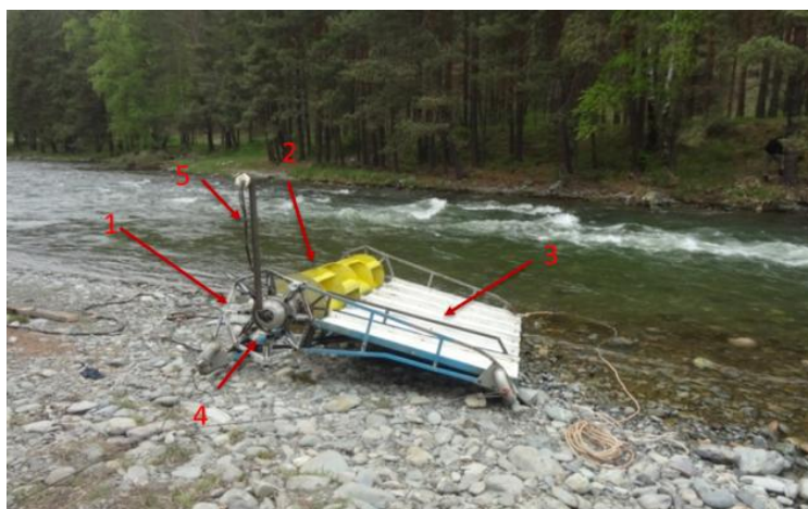
Рис. 3. Небольшая водная электростанция, предназначенная для погружения под воду вблизи русла реки (мощностью до 1,3 кВт)
