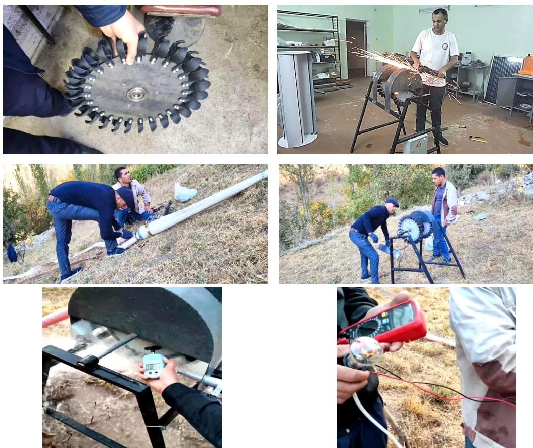
7-rasm. Mikro gidroenergetik qurilmasini yig'ish va tajriba-sinov ishlari jarayoni
