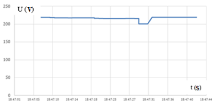
4-rasm. RQARQ dan iborat avtomatik rostlovchi qurilmaga ega bo'lgan AG ga 0,45 kW 0,9 kW va 3 kW aktiv quvvatli yuklamalar ketma-ket ulanganida chiqish kuchlanishining o'zgarishi ossillogrammasi.
