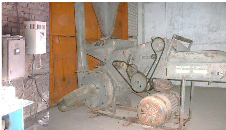
1-rasm. Universal yem maydalash qurilmasining asinxron motorini chastota o'zgartgich orqali boshqarish
