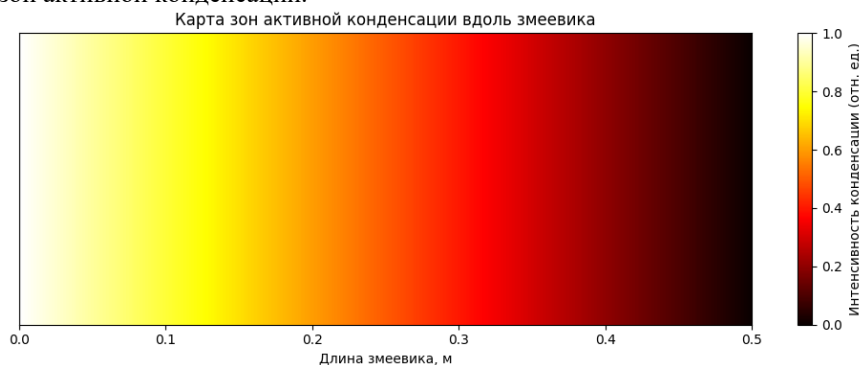
Рис.11. Карта интенсивности зон активной конденсации парогазовой смеси вдоль теплообменного змеевика Fig.11. Intensity map of the zones of active condensation of the vapor-gas mixture along the heat exchanger coil
