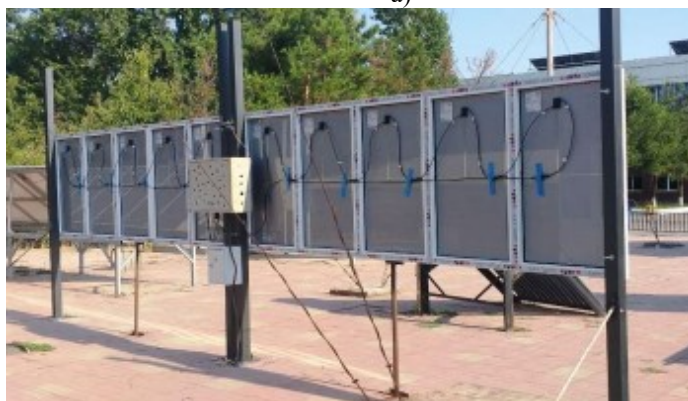
Рис.3. Фото экспериментальной фотоэлектрической установки мощностью 1 кВт. а) вид с фронтальной стороны; б) вид с тыльной стороны. Fig.3. Photo of an experimental photovoltaic installation with a capacity of 1 kW. а) view from the front; б) view from the back.
