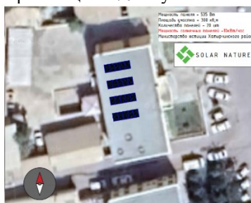
Рис.1. Спутниковый снимок с видимым расположением СФЭС мощностью 10 кВт на крыше административного здания Отдела юстиции Хатырчинского района
